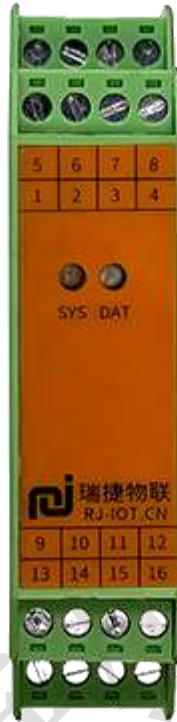
图 2.4 RJ218CAN模块接线端子排
