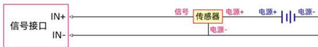
三线制电流信号采集差分接线图
