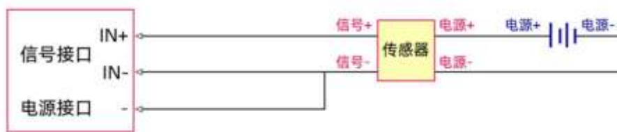
电压信号采集单端接线图
