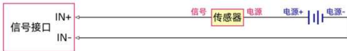
二线制电流信号采集差分接线图
