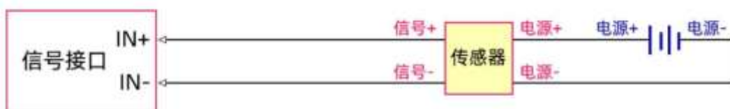
四线制电流信号采集差分接线图
