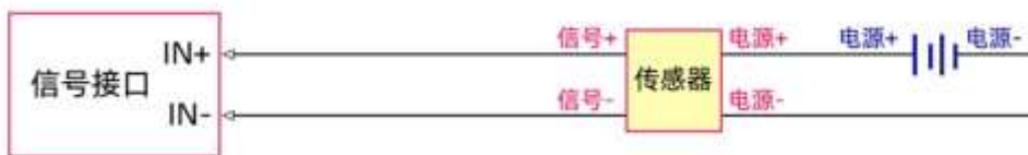
电压信号采集差分接线图
