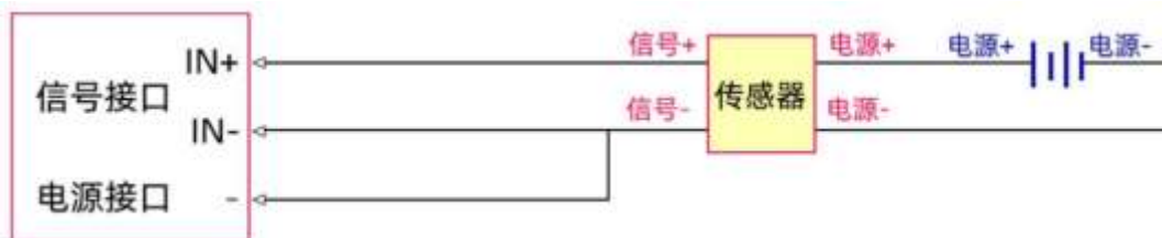
四线制电流信号采集单端接线图
