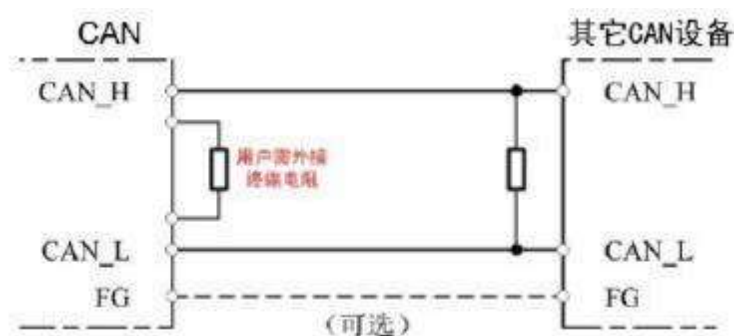
图 3.8 RJ278CAN 系列模块与其他 CAN 节点设备连接
